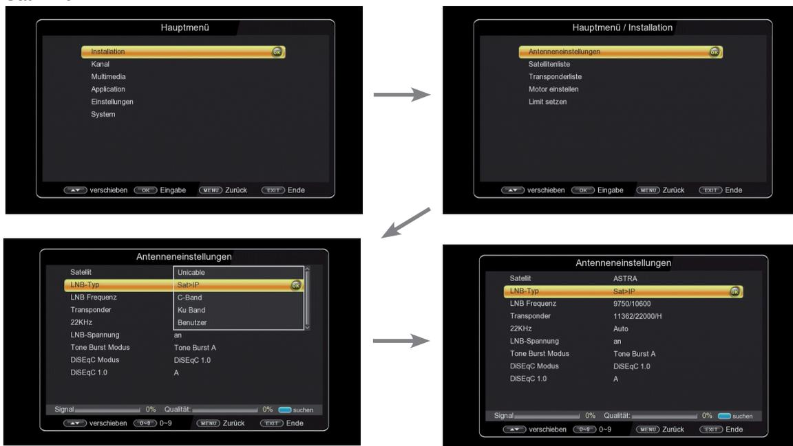
5. Verlassen Sie das Menü durch Drücken der Taste EXIT. Die Daten werden gespeichert. Das Gerät kann nun die Programme über den Sat>IP Router empfangen.
